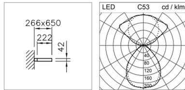
**WALL MOUNTED LUMINAIRE LEVEL CLD LED**
